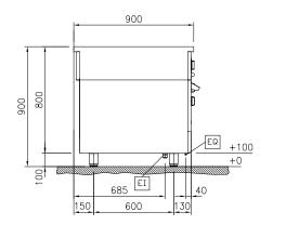
Electrical inlet (power) Equipotential screw
